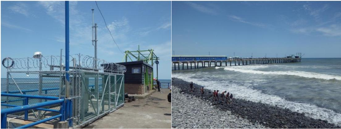
Figura 2. Mareógrafo con sensor ultrasónico instalado al final del muelle en La Libertad. La longitud del muelle es 200 m y la profundidad del nivel medio del mar al final del muelle es de 5 m, por lo que la pendiente promedio de la playa es 1:40.
